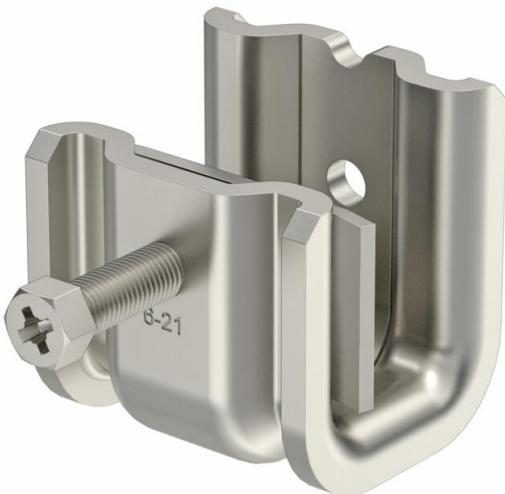
Este tipo de abrazadera de sujeción se desliza sobre el soporte y se fija al mismo, o al acero plano, mediante una cubeta de presión y un tornillo (M8). El tornillo de cabeza hexagonal tiene un ancho de llave de 10 mm. En el cuerpo de abrazadera se instalan además otras dos roscas M6 para fijar por ejemplo varillas roscadas.
