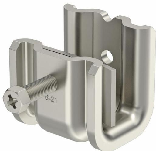
Este tipo de abrazadera de sujeción se desliza sobre el soporte y se fija al mismo, o al acero plano, mediante una cubeta de presión y un tornillo (M8). El tornillo de cabeza hexagonal tiene un ancho de llave de 10 mm. En el cuerpo de abrazadera se instalan además otras dos roscas M8 para fijar por ejemplo varillas roscadas.
