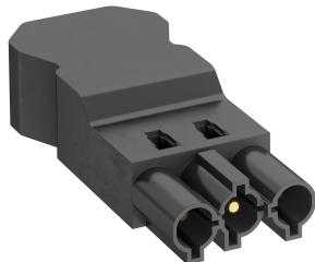
Conecotor de 3 polos, tipo GST18i con racor roscado para cables de 1,5 - 4,0 mm<sup>2</sup> y diámetros de cable de 10,5 - 14,5 mm (H05VV, NYM), sin montar con descarga de tracción, confeccionalbe in situ, 250 V, 16 A.
