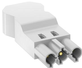
Conecotor de 3 polos, tipo GST18i con racor roscado para cables de 1,5 - 4,0 mm<sup>2</sup> y diámetros de cable de 10,5 - 14,5 mm (H05VV, NYM), sin montar con descarga de tracción, confeccionalble in situ, 250 V, 16 A.
