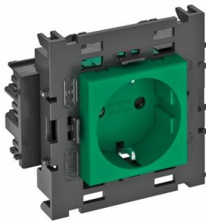
Toma de corriente con toma a tierra con conexión lateral simple, 0°, con protección elevada contra rozamiento, con bornes de enchufe, de 2 polos, 16 A, 250 V~, con bornes de unión según IEC 60884-1, adecuada para el montaje en sistemas de canal portamecanismos Rapid 80. Para la instalación en canales Rapid 45, canales portamecanismos, columnas de instalación, sistemas bajo pavimento y tomas Deskbox.
