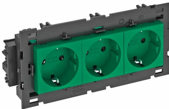
Toma de corriente con toma a tierra con conexión lateral triple, 0°, con protección elevada contra rozamiento, con bornes de enchufe, de 2 polos, 16 A, 250 V~, con bornes de unión según IEC 60884-1, adecuada para el montaje en sistemas de canal portamecanismos Rapid 80. Para la instalación en canales Rapid 45, canales portamecanismos, columnas de instalación, sistemas bajo pavimento y tomas Deskbox.
