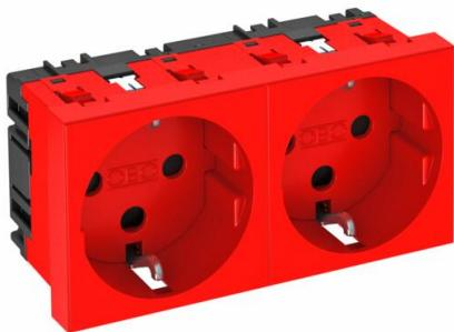
Toma de corriente con toma a tierra , versión codificada, con protección elevada contra rozamiento, con bornes de enchufe, de 2 polos, 16 A, 250 V~, con bornes de unión según IEC 60884-1.
