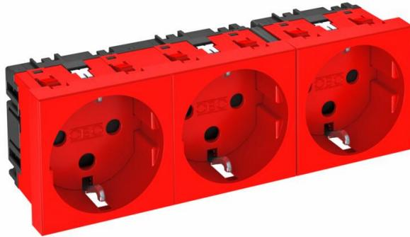
Toma de corriente con toma a tierra , versión codificada, con protección elevada contra rozamiento, con bornes de enchufe, de 2 polos, 16 A, 250 V~, con bornes de unión según IEC 60884-1.
