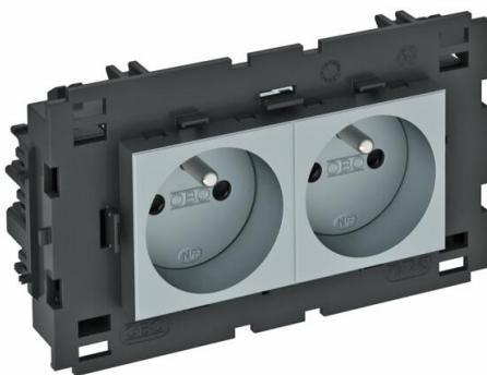
Toma de corriente con clavija de toma a tierra con conexión lateral doble, 0°, con protección elevada contra rozamiento, con bornes de enchufes, de 2 polos, 16 A, 250 V~, con bornes de unión según IEC 60884-1, adecuada para el montaje en sistemas de canal portamecanismos Rapid 80. Para la instalación en canales Rapid 45, canales portamecanismos, columnas de instalación, sistemas bajo pavimento y tomas Deskbox.
