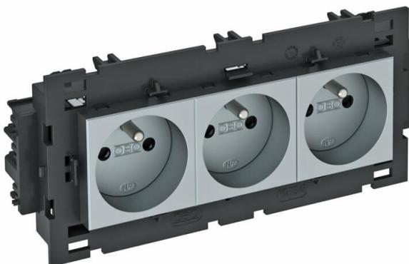
Toma de corriente con clavija de toma a tierra con conexión lateral triple, 0°, con protección elevada contra rozamiento, con bornes de enchufes, de 2 polos, 16 A, 250 V~, con bornes de unión según IEC 60884-1, adecuada para el montaje en sistemas de canal portamecanismos Rapid 80. Para la instalación en canales Rapid 45, canales portamecanismos, columnas de instalación, sistemas bajo pavimento y tomas Deskbox.
