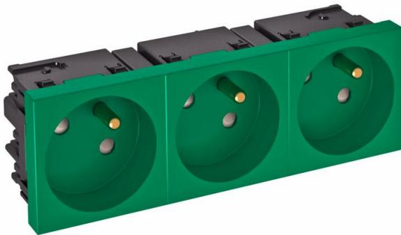
Toma de corriente con clavija de puesta a tierra con conexión lateral triple, 33°, con protección elevada contra rozamiento, con bornes de enchufes, de 2 polos, 16 A 250 V~, con bornes de unión según IEC 60884-1.
