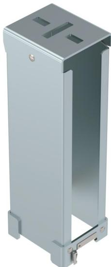
Soporte largo para montar módulos fotovoltaicos en tejados planos en combinación con el perfil de soporte TP 45/4700 y la abrazadera universal KLU. Ángulo de inclinación 15. Fijación por encaje en perfil de soporte.
