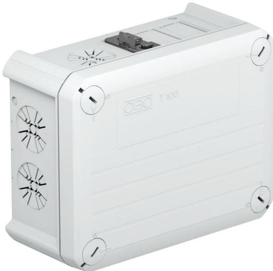
Caja de derivación con tomas Wieland 1S4+3B3 para la conexión de cables y líneas en zonas interiores y zonas exteriores protegidas. Forma rectangular con entradas ciegas en los lados y entradas ciegas en el suelo. Apropiado para el montaje en pared y techo, y el montaje en estructuras de chapa. Con la posibilidad de fijación interior y montaje mediante cúpulas esquineras. Tapa con cierre rápido, precintable. Fabricada con materiales libres de halógenos y resistentes a los rayos UV.
