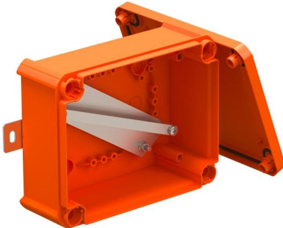
Caja de conexión o empalme de cables cerrada y sin montar para libre instalación con bornes cerámicos y prensaestopas. La dimensión A indica la longitud de carril de montaje disponible para los bornes de cableado. Suficiente espacio para cableado gracias a la disposición diagonal del carril de montaje. Fijación a bridas exteriores muy accesibles de acero inoxidable. Homologado para sistemas de cables con mantenimiento de función eléctrico según DIN 4102, parte 12, con las clases E30, E60 y E90.
