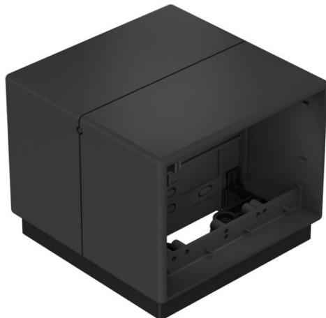
Para el montaje combinado de 4 mecanismos individuales con estribo de soporte (4 mecanismos de un tipo de corriente o dos grupos de 2 mecanismos con dos tipos de corriente). Las tomas con diferentes tipos de corriente se aíslan mediante una pared separadora. Con tornillos para el montaje de mecanismos con soporte de fijación: 60 mm, en vertical.
