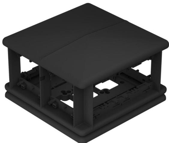
Unidad de instalación sobre el pavimento para el montaje de 8 mecanismos individuales con anillo o estribo de soporte en los 4 lados. La separación de los diferentes tipos de corriente (4 + 4) se consigue mediante una pared separadora. Si se utilizan mecanismos múltiples, se puede incrementar la capacidad de conexión. Con tornillos para el montaje de mecanismos con soporte de fijación: 60 mm, en vertical.
