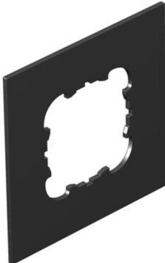
Tapeta con 1 troquel ( $\varnothing$  45 mm) para un mecanismo con anillo de soporte, para montar en la cara lateral menor de T4L y T8NL.
