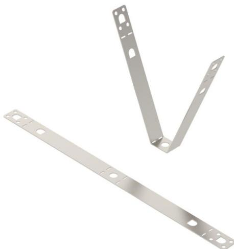
Fijación trapezoidal para la suspensión de sistemas de bandejas portacables en techos trapezoidales estándar. Ancho de perfil trapezoidal hasta 165 mm. Montaje con perno del tipo TPB R o tornillo de cabeza hexagonal del tipo SKS 10x110. El material de fijación se debe pedir por separado.
