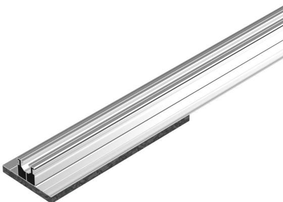
Perfil de soporte antideslizante para el montaje de módulos fotovoltaicos en tejados planos. Base para el alojamiento de apoyos cortos y largos STK y STL. Conexión longitudinal atornillable de varios perfiles de soporte con conectores longitudinales LV 35.
