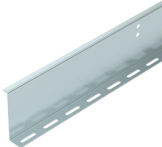
Tabique separador para el sistema de bandejas portacables transitables BKRS. Fijación con tornillos de cabeza alomada M 6 x 12 mm en el orificio de base. A partir de una anchura de 200 mm debe utilizarse un tabique separador con un tamaño máximo de compartimento de 220 mm.
