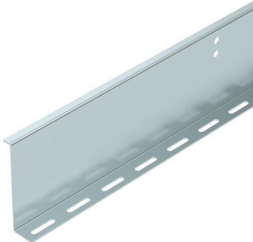
Tabique separador para el sistema de bandejas portacables transitables BKRS. Fijación con tornillos de cabeza alomada M 6 x 12 mm en el orificio de base. A partir de una anchura de 200 mm debe utilizarse un tabique separador con un tamaño máximo de compartimento de 220 mm.
