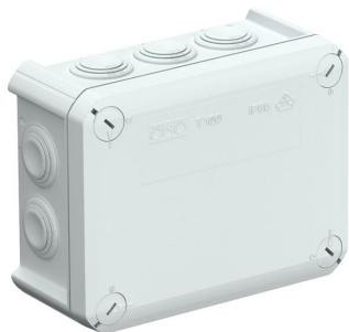
Caja de derivación para la conexión de cables y líneas en zonas interiores y zonas exteriores protegidas. Forma rectangular con juntas insertables en los lados y entradas ciegas en el suelo. Apropiado para el montaje en pared y techo, y el montaje en estructuras de chapa. Con la posibilidad de fijación interior y montaje mediante cúpulas esquineras. Tapa con cierre rápido, precintable. Fabricada con materiales libres de halógenos y resistentes a los rayos UV.
