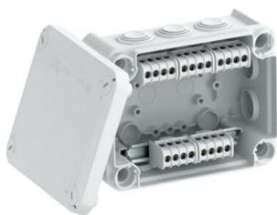
Caja de derivación con regleta de conexión para la conexión de cables y líneas en zonas interiores y zonas exteriores protegidas. Forma rectangular con juntas insertables en los lados y entradas ciegas en el suelo. Apropiado para el montaje en pared y techo, y el montaje en estructuras de chapa. Con la posibilidad de fijación interior y montaje mediante cúpulas esquineras. Tapa con cierre rápido, precintable. Fabricada con materiales libres de halógenos y resistentes a los rayos UV.
