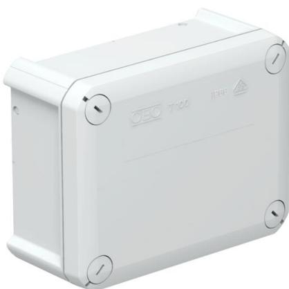
Caja de derivación para la conexión de cables y líneas en zonas interiores y zonas exteriores protegidas. Forma rectangular sin entradas. Apropiado para el montaje en pared y techo, y el montaje en estructuras de chapa. Con la posibilidad de fijación interior y montaje mediante cúpulas esquineras. Tapa con cierre rápido, precintable. Fabricada con materiales libres de halógenos y resistentes a los rayos UV.
