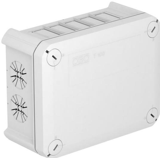
Caja de derivación para 6 tomas Wieland de 3 polos para la conexión de cables y líneas en zonas interiores y zonas exteriores protegidas. Forma rectangular con entradas ciegas en los lados y entradas ciegas en el suelo. Apropiado para el montaje en pared y techo, y el montaje en estructuras de chapa. Con la posibilidad de fijación interior y montaje mediante cúpulas esquineras. Tapa con cierre rápido, precintable. Fabricada con materiales libres de halógenos y resistentes a los rayos UV.
