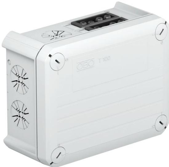
Caja de derivación con tomas Wieland 1w3p+1s3p para la conexión de cables y líneas en zonas interiores y zonas exteriores protegidas. Forma rectangular con entradas ciegas en los lados y entradas ciegas en el suelo. Apropiado para el montaje en pared y techo, y el montaje en estructuras de chapa. Con la posibilidad de fijación interior y montaje mediante cúpulas esquineras. Tapa con cierre rápido, precintable. Fabricada con materiales libres de halógenos y resistentes a los rayos UV.
