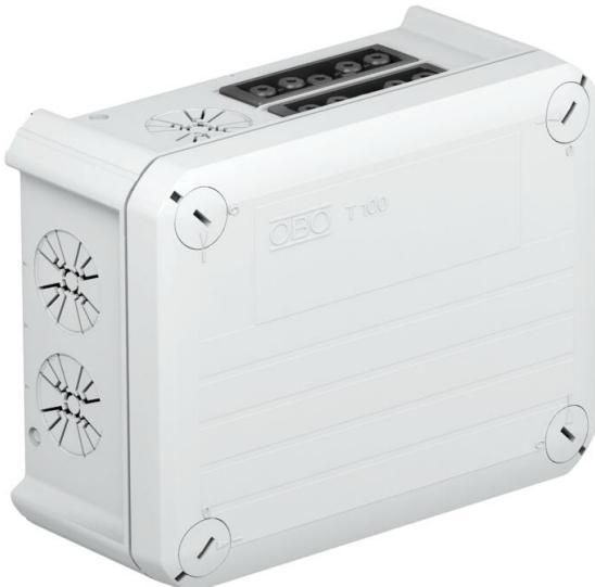
Caja de derivación con tomas Wieland 6s3p 3x2 para la conexión de cables y líneas en zonas interiores y zonas exteriores protegidas. Forma rectangular con entradas ciegas en los lados y entradas ciegas en el suelo. Apropiado para el montaje en pared y techo, y el montaje en estructuras de chapa. Con la posibilidad de fijación interior y montaje mediante cúpulas esquineras. Tapa con cierre rápido, precintable. Fabricada con materiales libres de halógenos y resistentes a los rayos UV.
