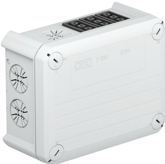
Caja de derivación con tomas Wieland 2s3p para la conexión de cables y líneas en zonas interiores y zonas exteriores protegidas. Forma rectangular con entradas ciegas en los lados y entradas ciegas en el suelo. Apropiado para el montaje en pared y techo, y el montaje en estructuras de chapa. Con la posibilidad de fijación interior y montaje mediante cúpulas esquineras. Tapa con cierre rápido, precintable. Fabricada con materiales libres de halógenos y resistentes a los rayos UV.
