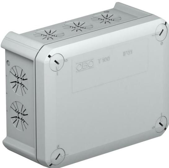
Caja de derivación con entradas con descarga de tracción para la conexión de cables y líneas en zonas interiores y zonas exteriores protegidas. Forma rectangular con entradas ciegas en los lados y entradas ciegas en el suelo. Apropiado para el montaje en pared y techo, y el montaje en estructuras de chapa. Con la posibilidad de fijación interior y montaje mediante cúpulas esquineras. Tapa con cierre rápido, precintable. Fabricada con materiales libres de halógenos y resistentes a los rayos UV.
