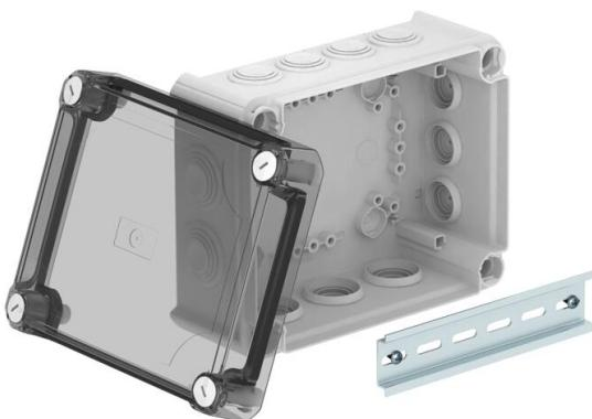
Caja de derivación para la conexión de cables y líneas en zonas interiores y zonas exteriores protegidas. Forma rectangular con juntas insertables en los lados y entradas ciegas en el suelo. Apropiado para el montaje en pared y techo, y el montaje en estructuras de chapa. Con la posibilidad de fijación interior y montaje mediante cúpulas esquineras. Tapa alta, transparente con cierre rápido, precintable. Fabricada con materiales libres de halógenos y resistentes a los rayos UV.
