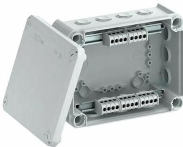
Caja de derivación con regleta de conexión para la conexión de cables y líneas en zonas interiores y zonas exteriores protegidas. Forma rectangular con juntas insertables en los lados y entradas ciegas en el suelo. Apropiado para el montaje en pared y techo, y el montaje en estructuras de chapa. Con la posibilidad de fijación interior y montaje mediante cúpulas esquineras. Tapa con cierre rápido, precintable. Fabricada con materiales libres de halógenos y resistentes a los rayos UV.
