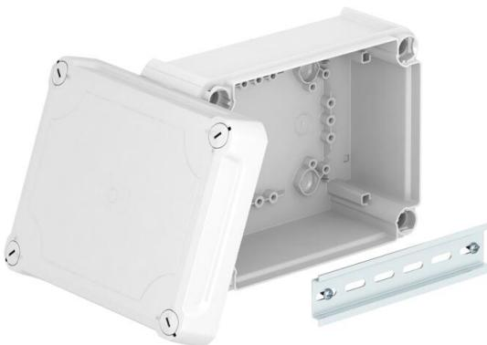
Caja de derivación cerrada para la conexión de cables y líneas en zonas interiores y zonas exteriores protegidas. Forma rectangular sin entradas. Apropiado para el montaje en pared y techo, y el montaje en estructuras de chapa. Con la posibilidad de fijación interior y montaje mediante cúpulas esquineras. Tapa alta con cierre rápido, precintable. Fabricada con materiales libres de halógenos y resistentes a los rayos UV.
