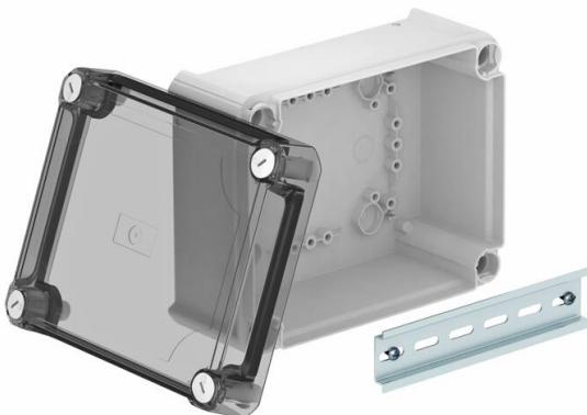
Caja de derivación cerrada para la conexión de cables y líneas en zonas interiores y zonas exteriores protegidas. Forma rectangular sin entradas. Apropiado para el montaje en pared y techo, y el montaje en estructuras de chapa. Con la posibilidad de fijación interior y montaje mediante cúpulas esquineras. Tapa alta, transparente con cierre rápido, precintable. Fabricada con materiales libres de halógenos y resistentes a los rayos UV.
