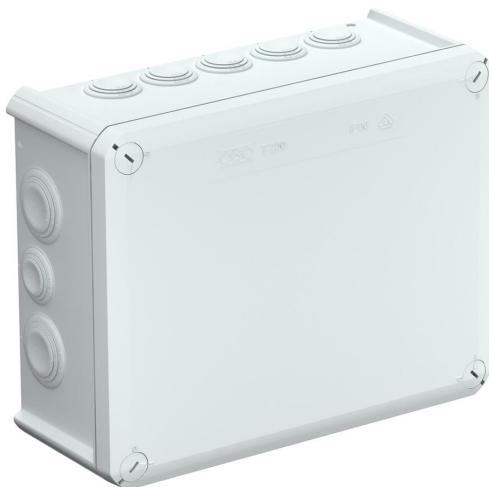
Caja de derivación para la conexión de cables y líneas en zonas interiores y zonas exteriores protegidas. Forma rectangular con juntas insertables en los lados y entradas ciegas en el suelo. Apropiado para el montaje en pared y techo, el montaje en estructuras de chapas y rosca en el suelo. Con la posibilidad de fijación interior y montaje mediante cúpulas esquineras. Tapa con cierre rápido, precintable. Fabricado con materiales sin halógenos. Modelo antiinflamable de polipropileno especial.
