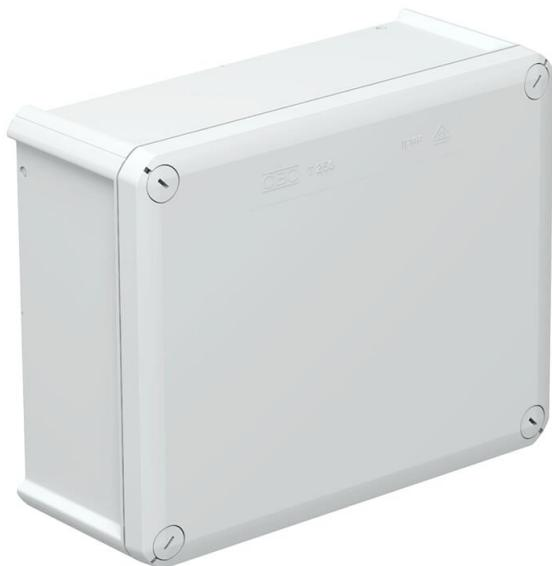
Caja de derivación para la conexión de cables y líneas en zonas interiores y zonas exteriores protegidas. Forma rectangular sin entradas. Apropiado para el montaje en pared y techo, el montaje en estructuras de chapas y rosca en el suelo. Con la posibilidad de fijación interior y montaje mediante cúpulas esquineras. Tapa con cierre rápido, precintable. Fabricada con materiales libres de halógenos y resistentes a los rayos UV.
