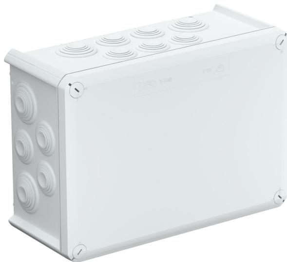
Caja de derivación para la conexión de cables y líneas en zonas interiores y zonas exteriores protegidas. Forma rectangular con juntas insertables en los lados y entradas ciegas en el suelo. Apropiado para el montaje en pared y techo, y el montaje en estructuras de chapa. Con la posibilidad de fijación interior y montaje mediante cúpulas esquineras. Tapa con cierre rápido, precintable. Fabricado con materiales sin halógenos. Modelo antiinflamable de polipropileno especial.
