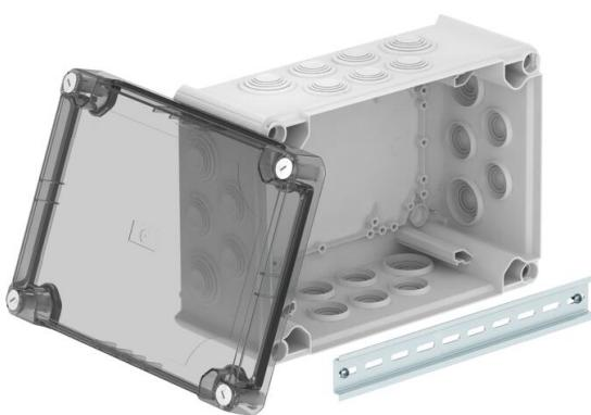
Caja de derivación para la conexión de cables y líneas en zonas interiores y zonas exteriores protegidas. Forma rectangular con juntas insertables. Apropiado para el montaje en pared y techo, el montaje en estructuras de chapas y rosca en el suelo. Con la posibilidad de fijación interior y montaje mediante cúpulas esquineras. Tapa alta, transparente con cierre rápido, precintable. Fabricada con materiales libres de halógenos y resistentes a los rayos UV.
