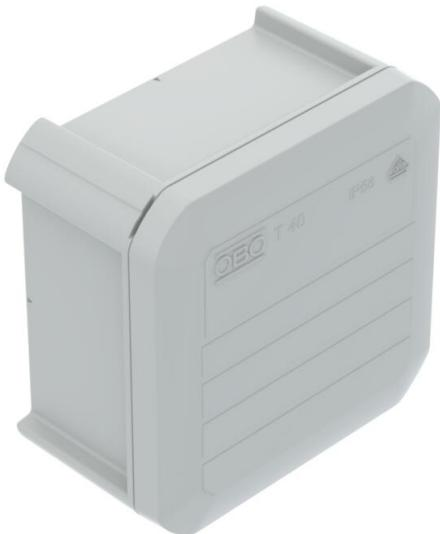
Caja de derivación para la conexión de cables y líneas en zonas interiores y zonas exteriores protegidas. Forma cuadrada sin entradas. Apropiado para el montaje en pared y techo, y el montaje en estructuras de chapa. Con la posibilidad de fijación interior y montaje mediante cúpulas esquineras. Con tapa de bornes fija. Fabricada con materiales libres de halógenos y resistentes a los rayos UV.
