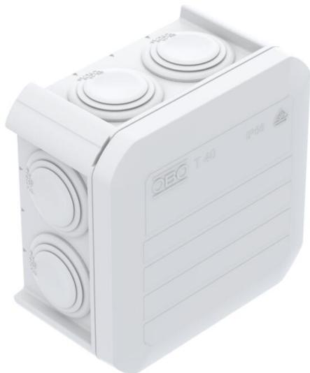
Caja de derivación para la conexión de cables y líneas en zonas interiores y zonas exteriores protegidas. Forma cuadrada con juntas insertables en los lados y entradas ciegas en el suelo. Apropiado para el montaje en pared y techo, y el montaje en estructuras de chapa. Con la posibilidad de fijación interior. Con tapa de bornes fija. Fabricada con materiales libres de halógenos y resistentes a los rayos UV.
