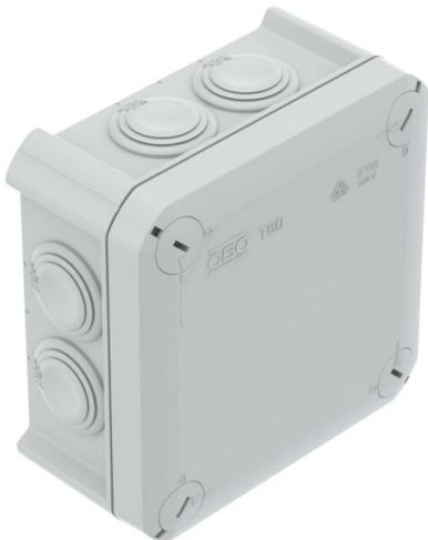
Caja de derivación para la conexión de cables y líneas en zonas interiores y zonas exteriores protegidas. Forma cuadrada con juntas insertables en los lados y entradas ciegas en el suelo. Apropiado para el montaje en pared y techo, y el montaje en estructuras de chapa. Con la posibilidad de fijación interior y montaje mediante cúpulas esquineras. Tapa con cierre rápido, precintable. Fabricado con materiales sin halógenos. Modelo antiinflamable de polipropileno especial.
