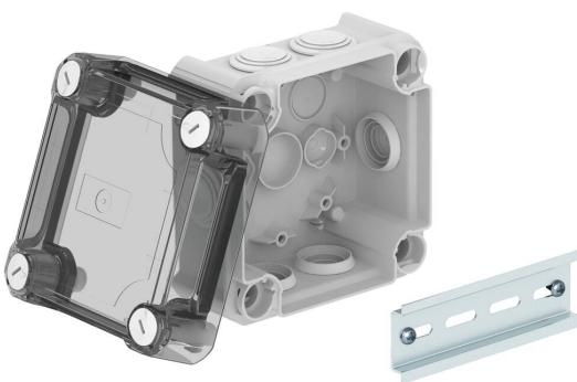
Caja de derivación para la conexión de cables y líneas en zonas interiores y zonas exteriores protegidas. Forma cuadrada con juntas insertables en los lados y entradas ciegas en el suelo. Apropiado para el montaje en pared y techo, y el montaje en estructuras de chapa. Con la posibilidad de fijación interior y montaje mediante cúpulas esquineras. Tapa alta, transparente con cierre rápido, precintable. Fabricada con materiales libres de halógenos y resistentes a los rayos UV.
