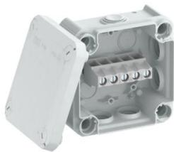
Caja de derivación con regleta de conexión para la conexión de cables y líneas en zonas interiores y zonas exteriores protegidas. Forma cuadrada con juntas insertables en los lados y entradas ciegas en el suelo. Apropiado para el montaje en pared y techo, y el montaje en estructuras de chapa. Con la posibilidad de fijación interior y montaje mediante cúpulas esquineras. Tapa con cierre rápido, precintable. Fabricada con materiales libres de halógenos y resistentes a los rayos UV.
