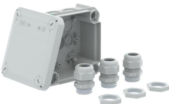
Caja de derivación para la conexión de cables y líneas en zonas interiores y zonas exteriores protegidas. Forma cuadrada con entradas ciegas en los lados y entradas ciegas en el suelo. Apropiado para el montaje en pared y techo, y el montaje en estructuras de chapa. Con la posibilidad de fijación interior y montaje mediante cúpulas esquineras. Tapa con cierre rápido, precintable. Fabricada con materiales libres de halógenos y resistentes a los rayos UV.
