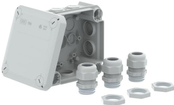
Caja de derivación para la conexión de cables y líneas en zonas interiores y zonas exteriores protegidas. Forma cuadrada con juntas insertables en los lados y entradas ciegas en el suelo. Apropiado para el montaje en pared y techo, y el montaje en estructuras de chapa. Con la posibilidad de fijación interior y montaje mediante cúpulas esquineras. Tapa con cierre rápido, precintable. Fabricada con materiales libres de halógenos y resistentes a los rayos UV.
