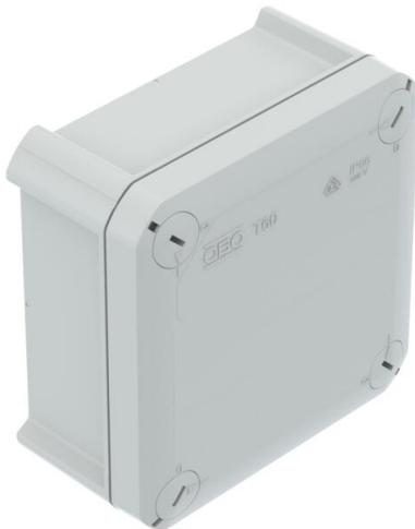
Caja de derivación para la conexión de cables y líneas en zonas interiores y zonas exteriores protegidas. Forma cuadrada sin entradas. Apropiado para el montaje en pared y techo, y el montaje en estructuras de chapa. Con la posibilidad de fijación interior y montaje mediante cúpulas esquineras. Tapa con cierre rápido, precintable. Fabricada con materiales libres de halógenos y resistentes a los rayos UV.
