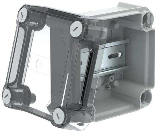
Caja de derivación cerrada para la conexión de cables y líneas en zonas interiores y zonas exteriores protegidas. Forma cuadrada sin entradas. Apropiado para el montaje en pared y techo, y el montaje en estructuras de chapa. Con la posibilidad de fijación interior y montaje mediante cúpulas esquineras. Tapa alta, transparente con cierre rápido, precintable. Fabricada con materiales libres de halógenos y resistentes a los rayos UV.
