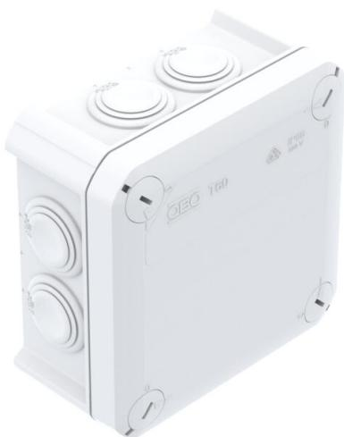
Caja de derivación para la conexión de cables y líneas en zonas interiores y zonas exteriores protegidas. Forma cuadrada con juntas insertables en los lados y entradas ciegas en el suelo. Apropiado para el montaje en pared y techo, y el montaje en estructuras de chapa. Con la posibilidad de fijación interior y montaje mediante cúpulas esquineras. Tapa con cierre rápido, precintable. Fabricada con materiales libres de halógenos y resistentes a los rayos UV.
