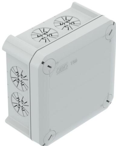
Caja de derivación con entradas con descarga de tracción para la conexión de cables y líneas en zonas interiores y zonas exteriores protegidas. Forma cuadrada con entradas ciegas en los lados y entradas ciegas en el suelo. Apropiado para el montaje en pared y techo, y el montaje en estructuras de chapa. Con la posibilidad de fijación interior y montaje mediante cúpulas esquineras. Tapa con cierre rápido, precintable. Fabricada con materiales libres de halógenos y resistentes a los rayos UV.
