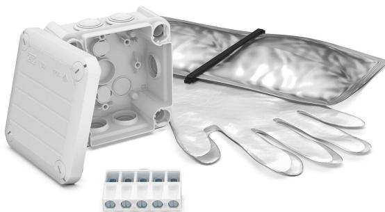
Juego compuesto de caja de derivación T 60 con regleta de bornes, resina de moldeo y un par de guantes de un solo uso. Resina de moldeo de 2 componentes en la bolsa de mezcla para la protección de la instalación eléctrica contra la humedad según la clase de protección IP 68 y cargas mecánicas. La resina de moldeo tiene una temperatura de endurecimiento baja y una temperatura de aplicación de 0-35 °C. La cantidad de resina de moldeo corresponde al volumen de la caja.
