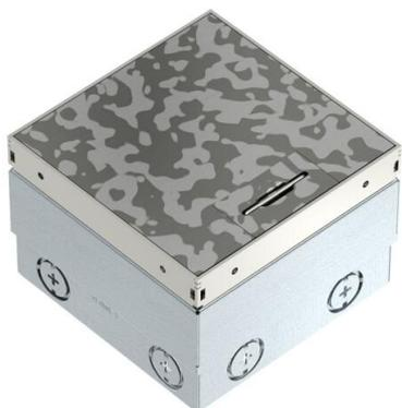
Unidad completa cuadrada para el montaje en suelos huecos y en pavimentos que precisan una limpieza en seco en zonas interiores. La carcasa empotrable dispone de entradas pretroqueladas para tubo (M20/M25). Se puede ajustar la tapa hasta el borde superior del revestimiento del suelo mediante 4 soportes niveladores. La profundidad mínima de montaje es de 100 mm y el margen de nivelación de + 35 mm.
